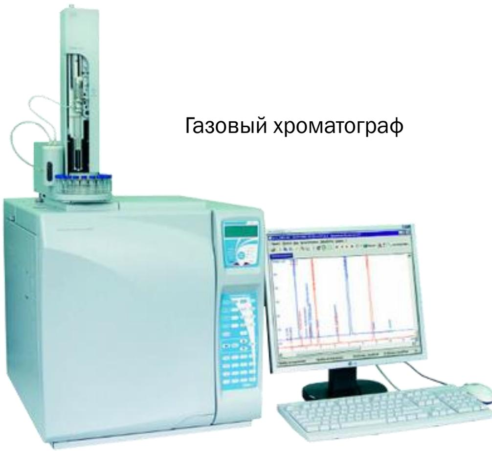
Метод предназначен для анализа смесей органических соединений и заключается в их разделении на колонке хроматографа с последовательным выходом компонентов из колонки в ионный источник масс-спектрометра, где происходит их ионизация.
